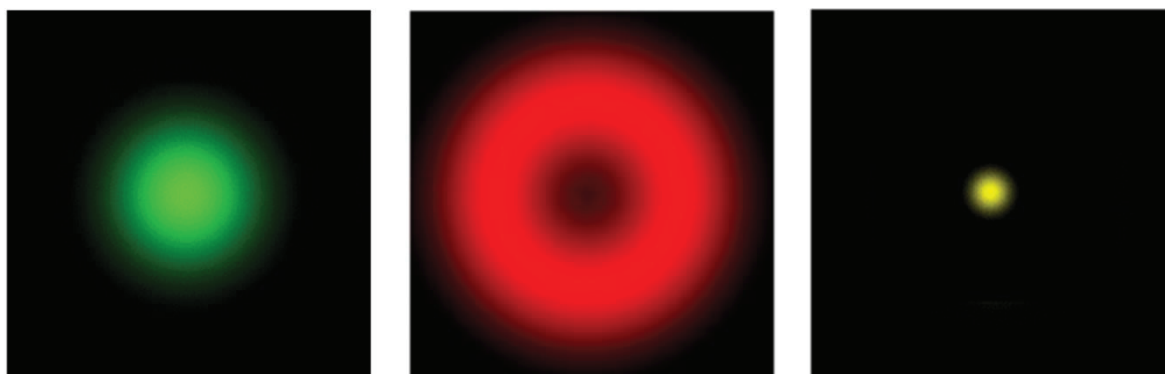
Ryc. 1. Ograniczone dyfrakcyjne wzbudzenie z lasera SuperK (po lewej), ubytek w kształcie zbliżonym do pączka z lasera Katana-HP (centrum), super-rozdzielczy sygnał fluorescencji po wyczerpaniu (po prawej) [2]
