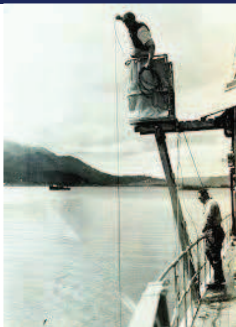
Ryc. 2. Marynarz rzucający sondą ręczną w celu pomiaru głębokości wody, 1963 rok, ( https://seabed2030.org/sites/default/files/documents/seabed_2030_roadmap_v11_2020.pdf )
